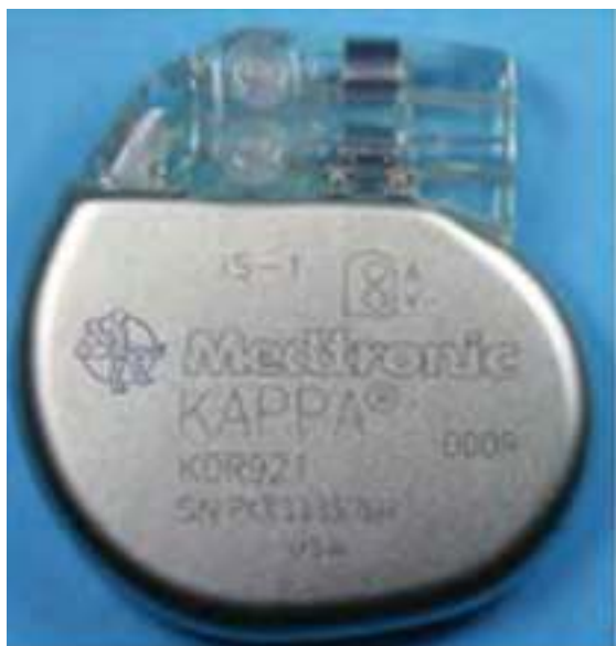
تصویر ۵- مجموعه باتری و مدار الکترونیکی در یک قاب فلزی به نام CAN قرار دارند
